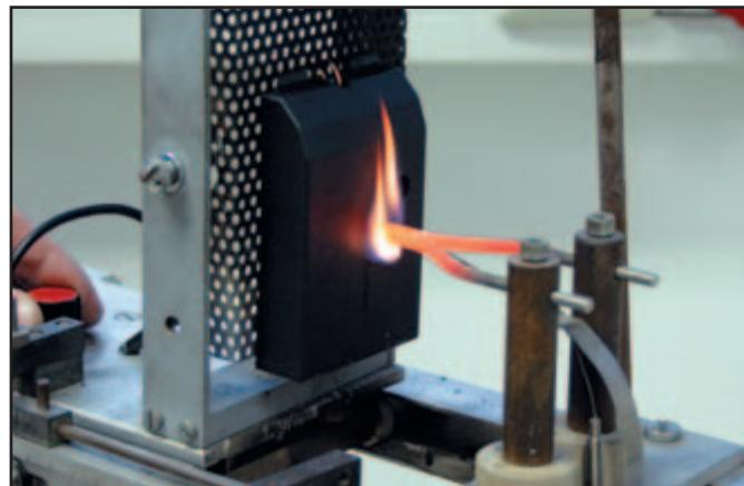
В настоящее время все контактные части и изоляция электрических соединений токонесущих элементов с номинальным током  $I > 0,2$  А должны выдерживать испытание раскаленной проволокой при 750°C в соответствии со стандартом IEC 60695.
