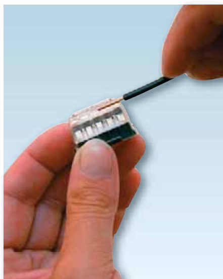
Zaizolować przewód na długości 8–9 mm Zbavení vodiče izolace v délce 8-9 mm
